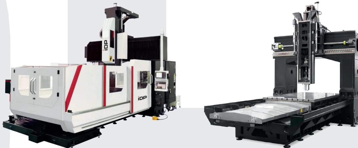
Портальные обрабатывающие центры серии BMT имеют неподвижный портал с интегрированной колонной и балкой, и подвижным столом. Оснащены мощным шпинделем с высоким моментом с возможностью применения приводных систем.
