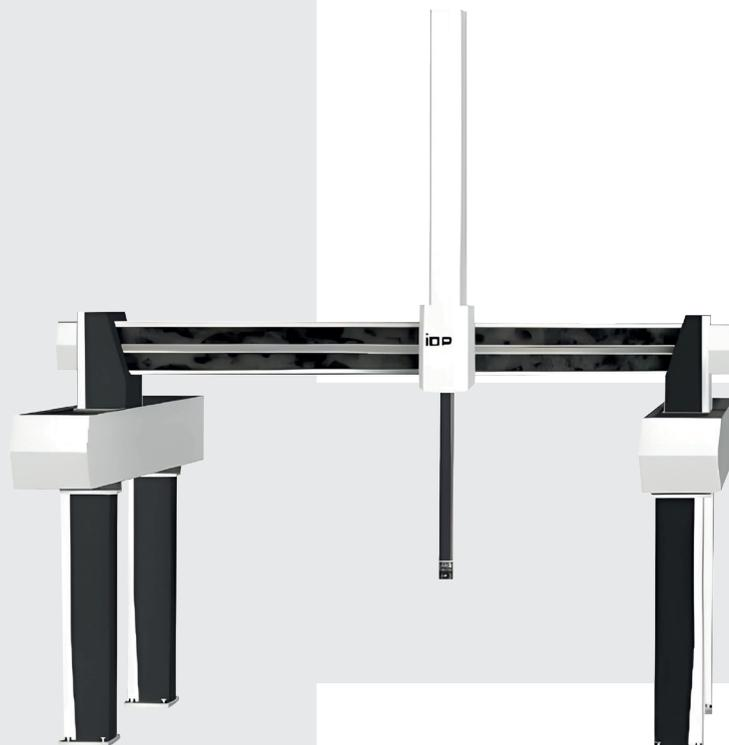
Мостовой тип координатно-измерительных машин с перемещаемым порталом предназначен для измерений крупногабаритных деталей с определением отклонений размеров, формы и взаимного расположения поверхностей. Для расширения решаемых задач могут комплектоваться контактными триггерными и сканирующими, оптически-ми и лазерными датчиками.
