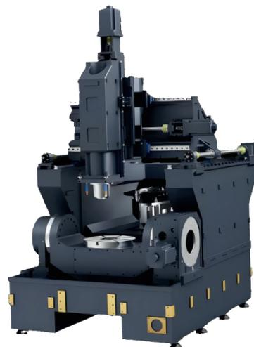
Обрабатывающие центры серии FG имеют широкий спектр применения в различных отраслях машиностроения при изготовлении деталей сложной геометрической формы с высокими требованиями к точности. Позволяют осуществлять непрерывную 5-ти осевую обработку. Конструкция станка порталная, встроенные колонны с размещенным на них наклонно-поворотным столом и балкой со шпиндельным узлом. Станок обладает большой жесткостью, несущей способностью и, как следствие, стабильной высокой точностью.
